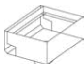
Revisionsschacht mit Anschluss unten
